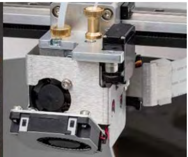
Druckkopf mit beiden Düsen - Quelle: Markforged
