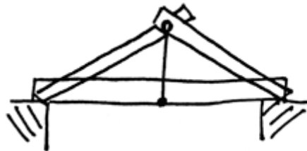
Brücke nach Binderkonstruktion (Biegung massiv reduziert)
