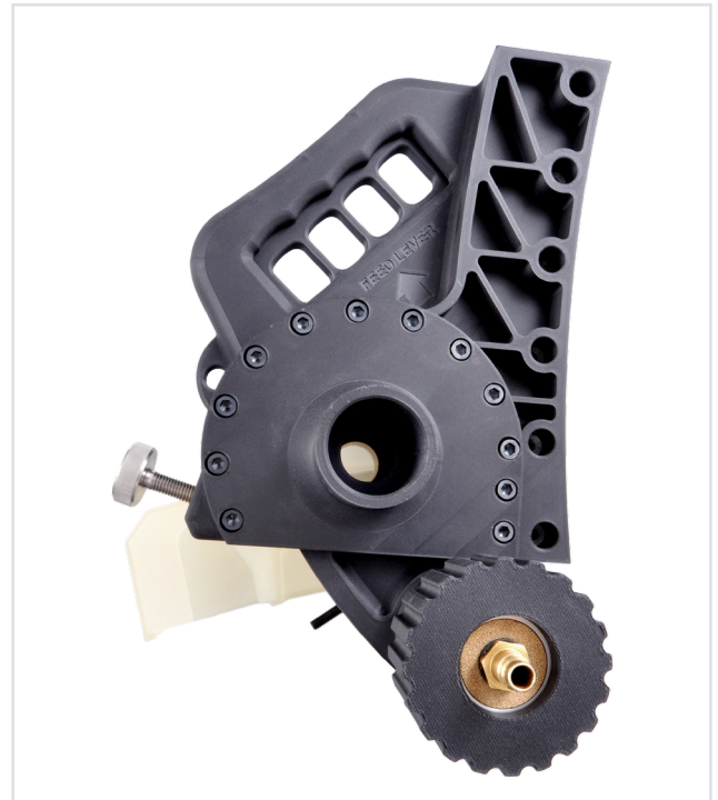
Das Siemens-Kreissägengehäuse wurde mit Onyx, einer Nylonbasis mit gehackten Kohlefasern, gedruckt und anschließend mit einer durchgehenden Kohlefaser verstärkt.
