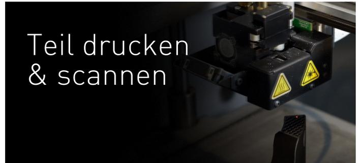
Blacksmith nutzt den integrierten Laser und einen patentierten, intelligenten Scanprozess, um Teile während des Drucks zuverlässig zu vermessen.
