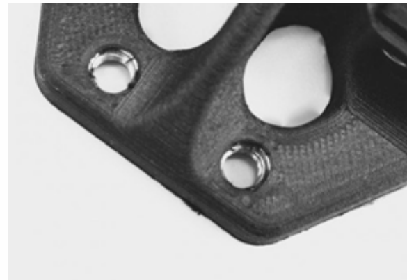
Eingelegte Muttern im 3D-gedruckten Bauteil - Quelle: Markforged
