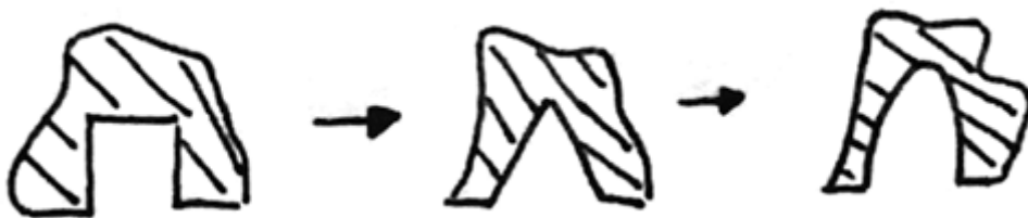
Überhänge konstruktiv vermeiden
