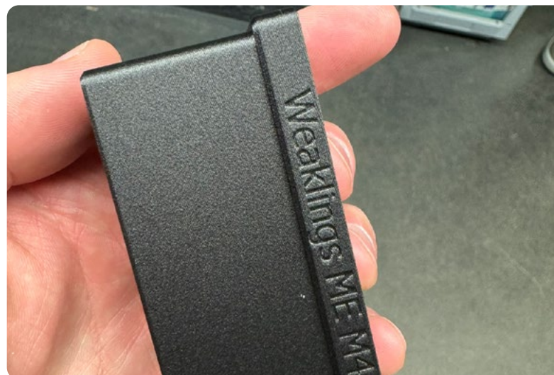
Bauteil-Bezeichnungen und Artikelnummern können einfach mit aufgedruckt werden.
