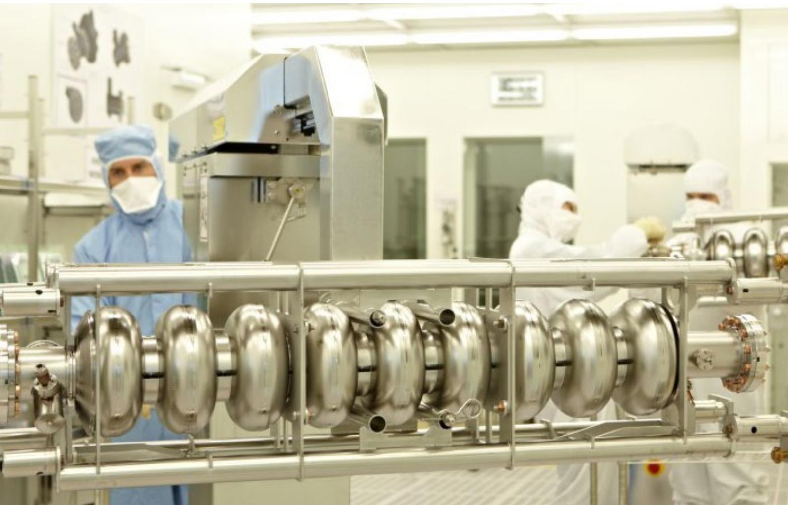
Hochfrequenzresonator in der Fertigung bei Ri Research Instruments in Overath.
