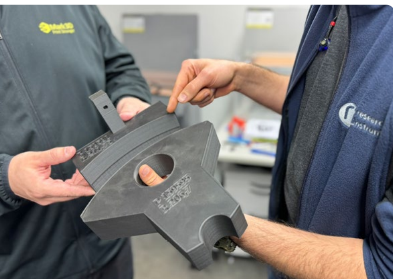
3D gedruckte Vorrichtung verstärkt mit der Carbon-Endlosfaser Technologie.
