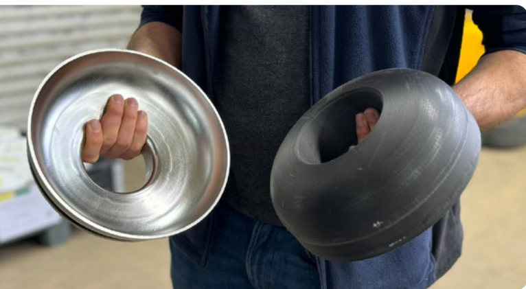
3D gedrucktes Tiefziehwerkzeug (Prägestempel), für Niob-Material mit 3mm Wandstärke.
