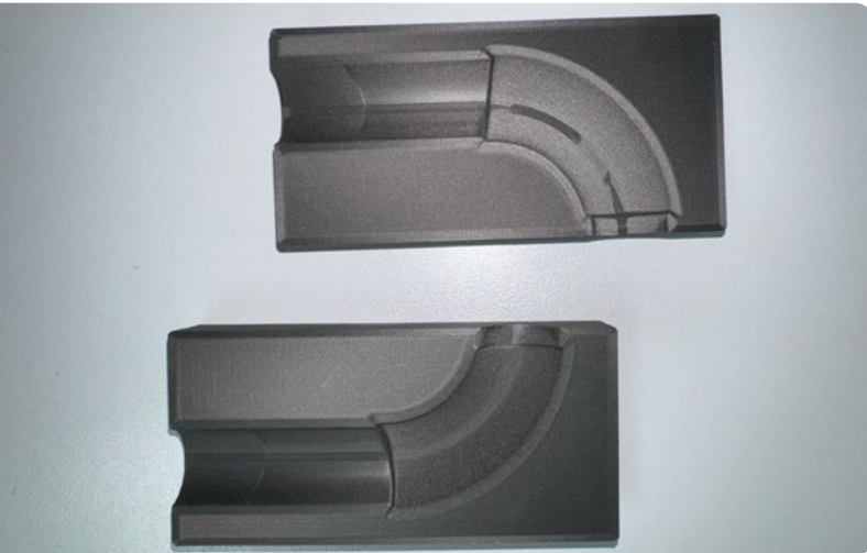
3D gedruckte Sandguss-Form.
