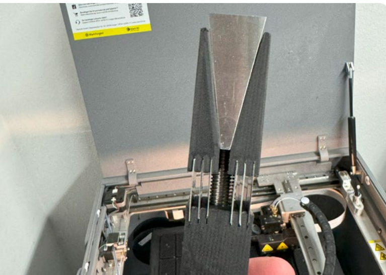
Bauteil aus dem 3D-Drucker mit integrierten Funktionen und Einlegeteilen.
