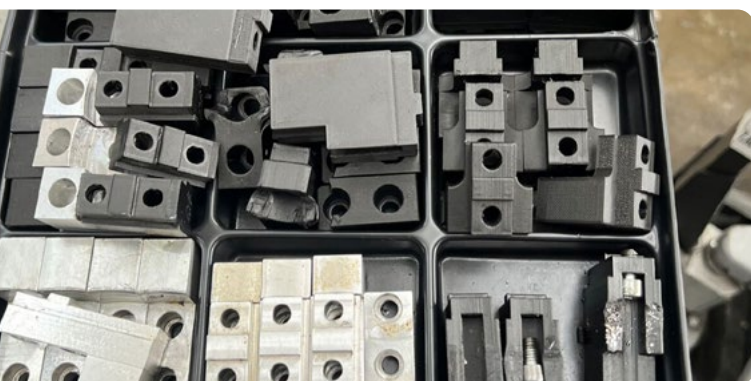
Betriebsmittel aus Aluminium und 3D gedruckt.
