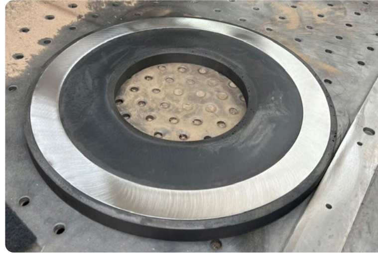
3D gedruckte Bohrschablone.
