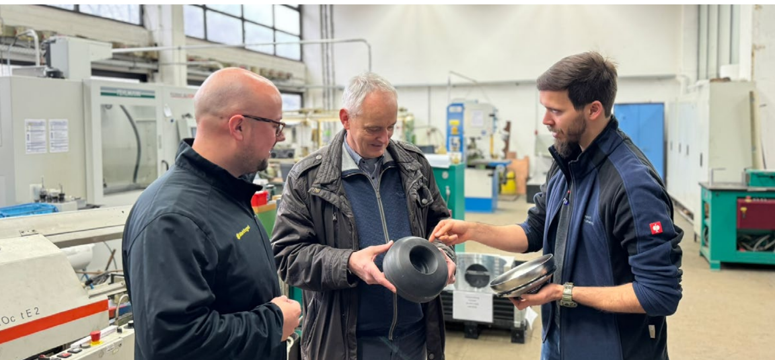
Ferdinand Bunte (links Mark3D) bespricht mit Peter vom Stein und Joël Grüne von Ri Research Instruments einen Prägestempel (Tiefziehwerkzeug) für die Herstellung von Hochfrequenz Resonatoren.
